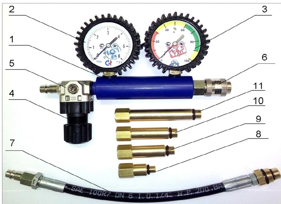
Рис. 1. Пневмотестер «Ait-Test»
