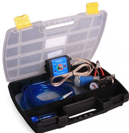
Дымогенератор G-Smoke с таймером и регулятором плотности дыма необходим при диагностике автомобиля, когда требуется обнаружить негерметичность в узлах и системах, влияющих на работу двигателя и электронного блока управления. К таким узлам и системам относятся: система впускного тракта воздуха, система выпуска выхлопных газов, система охлаждения и прочие.
