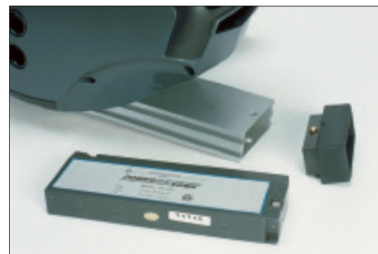
В каждом датчике DSP500XF используется свинцово-кислотная аккумуляторная батарея на 12 В, которая может быть легко заменена оператором.
