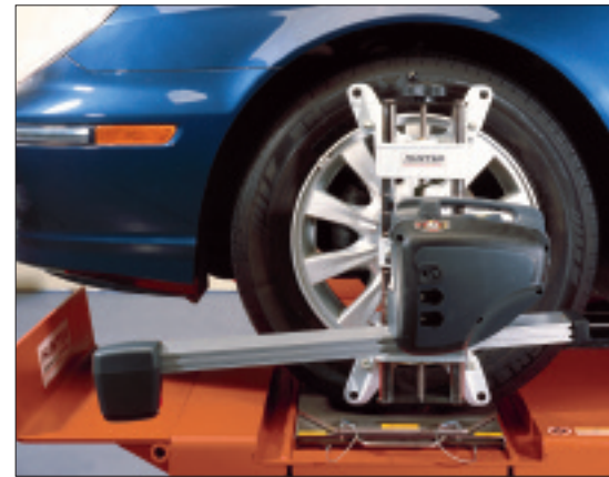
Беспроводные датчики DSP500XF предлагают такую же высокую скорость передачи данных, что и стандартные датчики серии DSP500, не требуя дополнительного времени на подключение кабелей.
