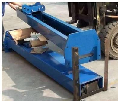
5. Поднимите нижнюю колонну погрузчиком и снимите сцепляющие пластины
