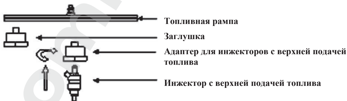
Рис. 2.1 Установка адаптера инжектора с верхней подачей топлива
