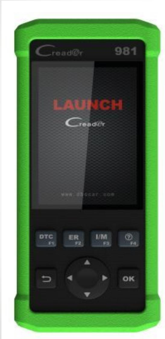
**CR981** – компактный прибор для технического обслуживания автомобиля, объединяющий стандартную OBDII/EOBD диагностику и 11 специальных функций сброса. CR981 имеет 4.0-дюймовый цветной экран и поддерживает более 40 марок европейских, американских и азиатских автопроизводителей.
