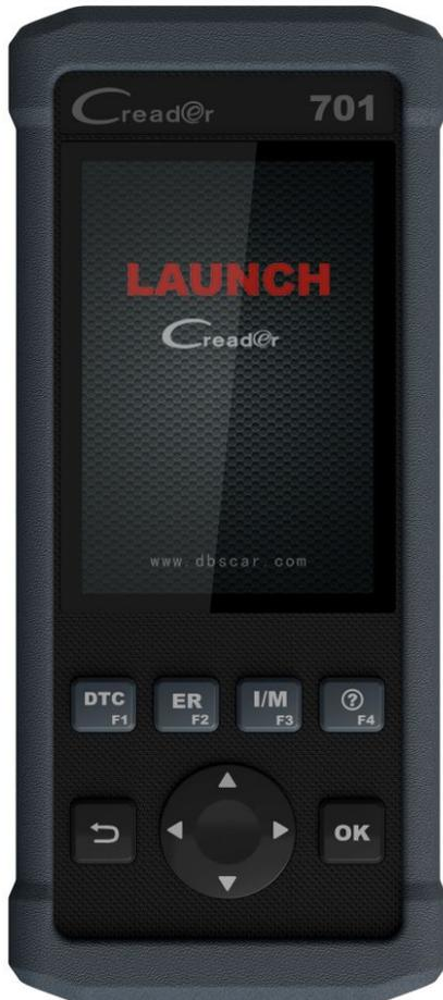
**CReader 701** – серия многофункциональных считывателей кодов ошибок с большим цветным дисплеем. Каждый прибор в этой серии кроме полной OBDII/EOBD диагностики имеет также одну или несколько из следующих спецфункций для удовлетворения различных требований: OIL RESET, EPB RESET, TPMS RESET, BMS RESET, SAS RESET, DPF RESET. CR701 тип А содержит функции OIL RESET и EPB RESET.
