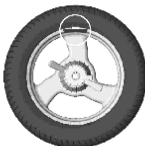
Рисунок 6.6 - Груз установлен в «12 часов»
