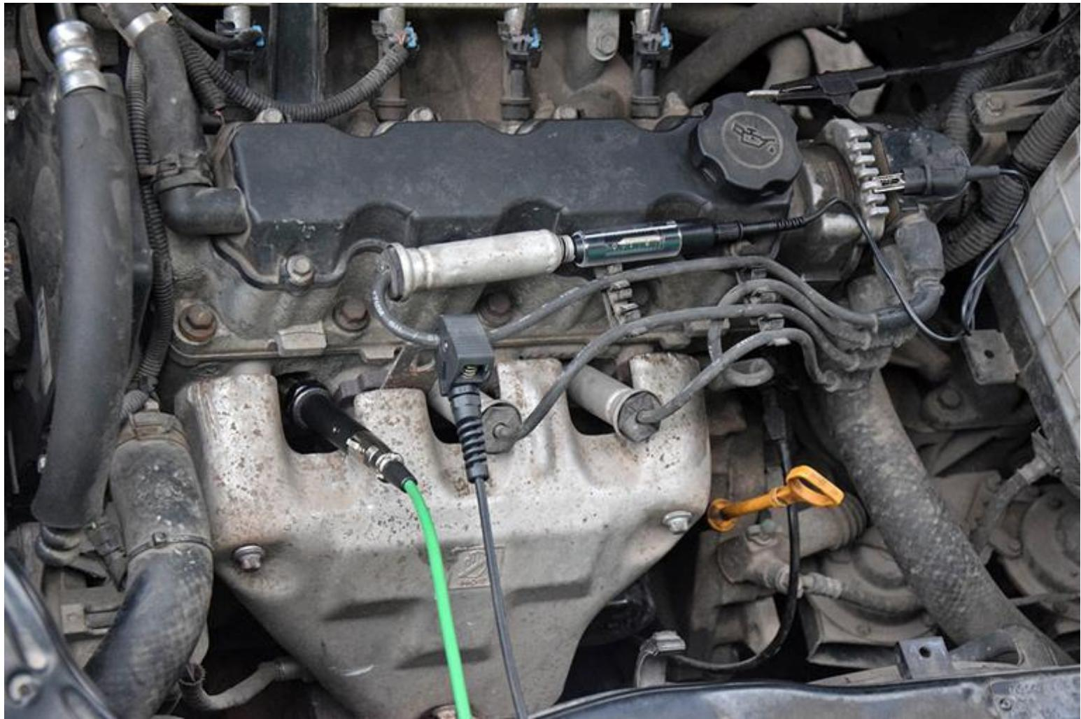
Скрипт Px при помощи датчика давления, вкрученного на место свечи зажигания, позволяет проверить характеристики цилиндра, впускного и выпускного трактов, системы регулирования угла опережения зажигания и оценить взаимное влияние этих систем друг на друга.
