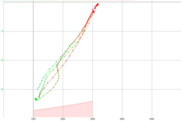
Если в процессе измерений задействовать датчик синхронизации, то дополнительно проверяются ещё и углы опережения зажигания. Данный способ измерения является наиболее точным, так как сопоставляются реальный момент искрообразования (измеряется при помощи датчика синхронизации) с реальной верхней мёртвой точкой (пик давления в цилиндре). При этом УОЗ контролируется не только при работе двигателя на холостом ходу, но и на остальных режимах работы двигателя.
