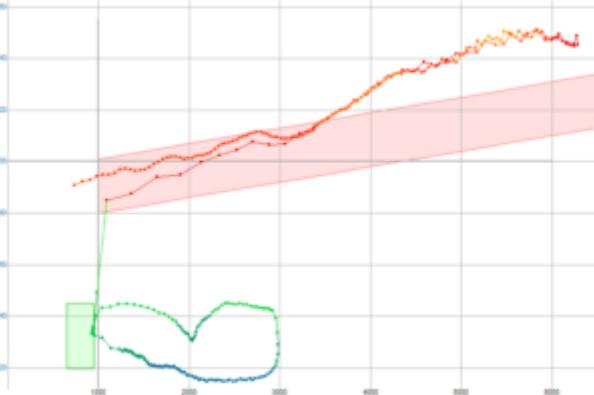
По полученным результатам видно, что турбина начинает работать на оборотах выше 3000 RPM и увеличивает отдаваемый двигателем врачающий момент приблизительно на 20 % в диапазоне оборотов 4000...6000 RPM.
