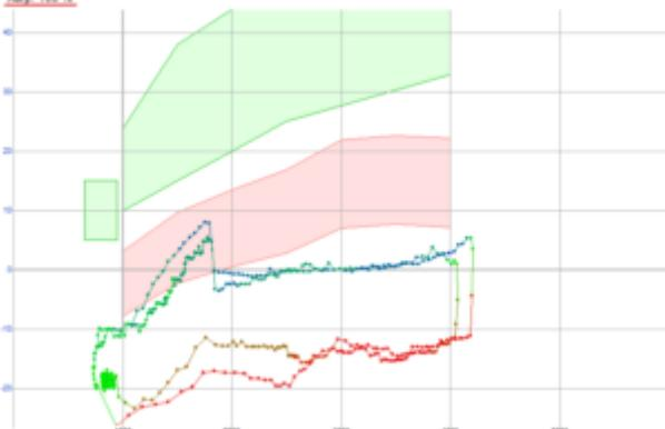
Показанный выше пример демонстрирует неправильную начальную установку УОЗ. Но, обратите внимание на то, что он получен на автомобиле Mitsubishi Lancer IX 2007-го года выпуска с двигателем 4G18 рабочим объёмом 1.6, где регулировка УОЗ не предусмотрена конструктивно, так как он не оснащён механическим распределителем зажигания.
