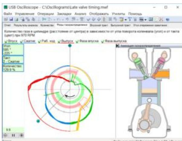
Но, при повседневной работе со скриптом вовсе необязательно исследовать эту диаграмму вручную, так как скрипт самостоятельно измеряет углы открытия и закрытия клапанов и оценивает их влияние на работу двигателя. В первую очередь оценивается наполняемость цилиндра свежей топливо-воздушной смесью; ведь именно этот параметр ограничивает максимальные мощность и врачающий момент двигателя.
