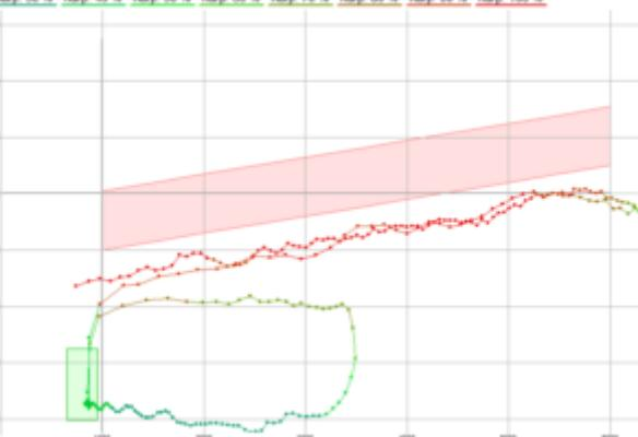
При этом, фрагменты диаграммы красного цвета (соответствуют резкой перегазовке) располагаются ниже пределов типовой зоны.
