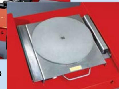
PowerSlide® автоматически блокирует и разблокирует поворотные круги в соответствующее время. Оператор больше не должен ходить вокруг подъемника, теряя время на то, чтобы заблокировать и разблокировать шплинты.
