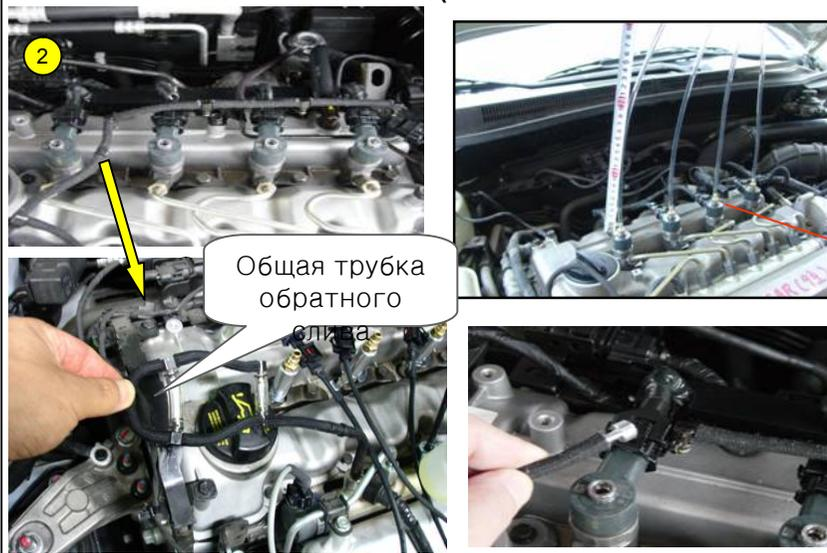
Назначение – оценка обратного потока форсунок, проверка ТНВД
