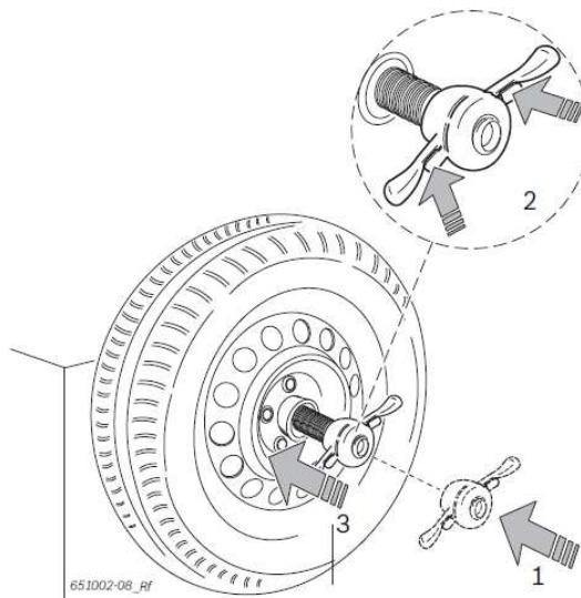
5. Ослабьте деблокирование и поворачивайте быстrozажимную гайку по часовой стрелке до тех пор, пока колесо не будет прочно зажато.
