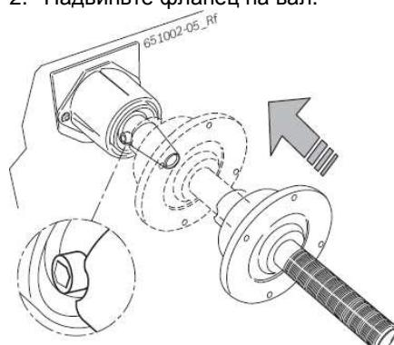
3. Затяните до отказа винт с шестигранным отверстием в головке.
