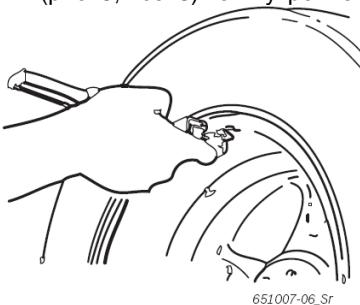
2. Приведите щипцы для наружных грузиков (поз. 5) в соответствующее положение, в котором должны закрепляться балансировочные грузики.
