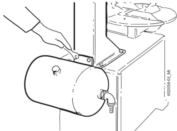
2. Введите резиновую трубку в подключение по воздуху к резервуару с воздухом и затяните хомут для шлангов.
