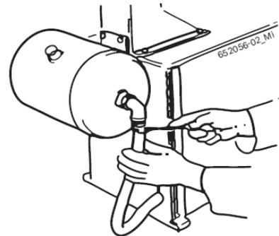
3. Закрепите крепление для манометра на монтажной колонне при помощи двух входящих в комплектацию винтов.
