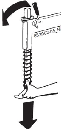
3. Вытяните вертикальную стойку, вытащите пружину и затем вставьте вертикальную стойку вновь в ее посадочное место и закрепите в положении конечного упора.
